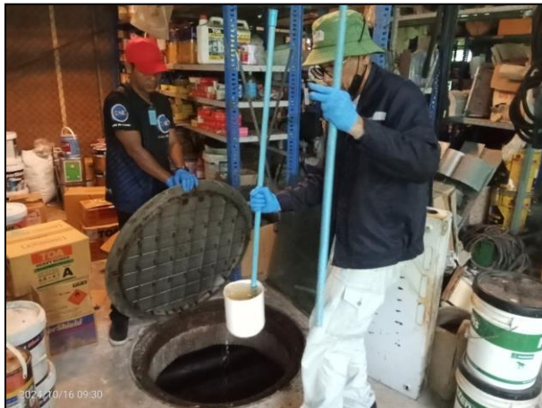
รูปที่ 3.1 จุดเก็บตัวอย่างน้ำเสียก่อนเข้าระบบบำบัด
