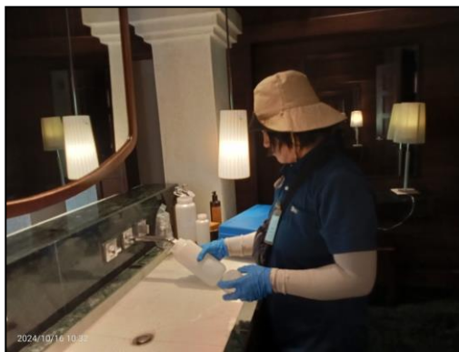
รูปที่ 3.4 การเก็บตัวอย่างน้ำใช้ภายในโรงแรม
